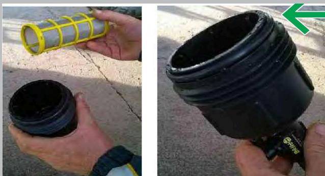
6. Извлеките фильтры из корпуса, промойте чистой водой и убедитесь, что они не сломаны и что их кольца находятся в хорошем состоянии.
